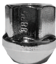
Chromé Ouvert M14 x 1.50 Hex: 22mm Longueur: 26mm Siège: 60° Acier Solide
