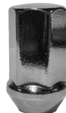
Gland Chromé M14 x 1.50 Hex: 22mm Longueur: 45mm Siège: 60° Acier Solide
