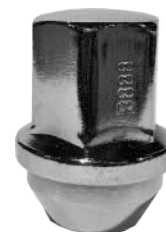
Gland Chromé M14 x 1.50 Hex: 22mm Longueur: 39mm Siège: 60° Acier Solide
