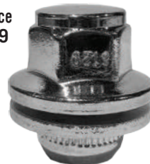
Gland Chromé M14 x 1.50 Hex: 22mm Longueur: 35mm Siège: MAG Acier Solide
