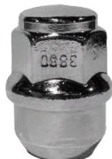
Dôme Chromé à Glands M14 x 1.50 Hex: 21mm Longueur: 37mm Siège: 60° Acier Solide
