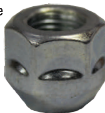
Zinc Ouvert M14 x 1.50 Hex: 22mm Longueur: 22mm Siège: 60° Acier Solide
