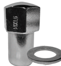
Chromé Avec Rondelle M14 x 1.50 Hex: 22mm Longueur: 43mm Siège: MAG Acier Solide
