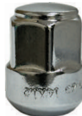
Gland Chromé M14 x 1.50 Hex: 22mm Longueur: 35mm Siège: Radius Acier Solide
