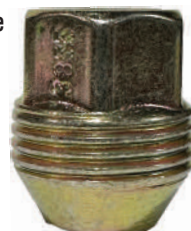
Zinc Filetage Externe M14 x 1.50 Hex: 22mm Longueur: 30mm Siège: 60° Acier Solide
