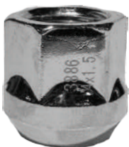
Chromé Ouvert M14 x 1.50 Hex: 19mm Longueur: 21mm Siège: 60° Acier Solide
