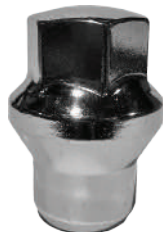
Dôme Chromé à Glands M14 x 1.50 Hex: 21mm Longueur: 42mm Siège: MAG Acier Solide
