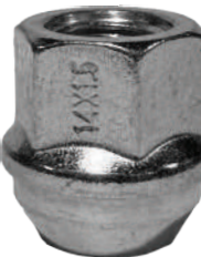
Zinc Ouvert M14 x 1.50 Hex: 21mm Longueur: 26mm Siège: 60° Acier Solide
